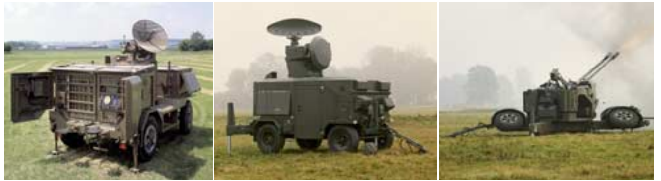
Die Flugabwehrsysteme (v.l.n.r.) von Oerlikon Contraves (Feuerleitgeräte Superfledermaus, Skyguard und 35 mm Zwillingsgeschütz) sind für den langfristigen Einsatz entwickelt. Seit Jahrzehnten wird die Kampfwerterhaltung durch Ersatzteilversorgung gesichert.
