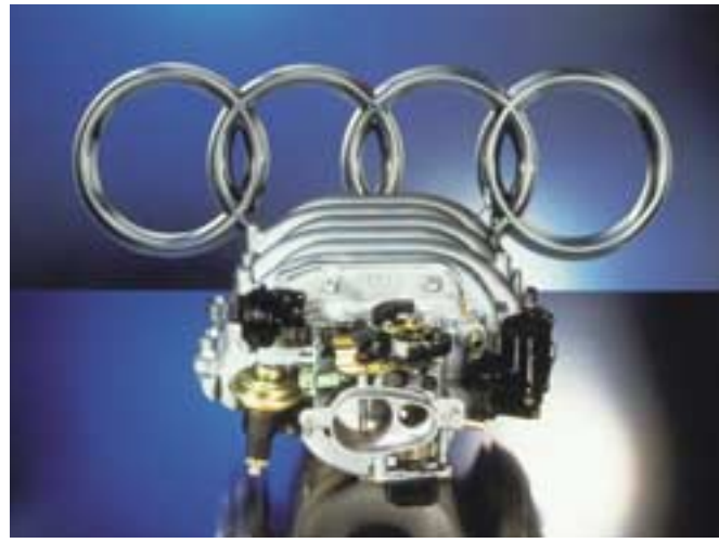
Ob aus Stahlguss, Aluminium, Magnesium oder Kunststoff – Komponenten für das Luftmanagement des Motors bilden ein zentrales Kompetenzfeld der Pierburg GmbH. Saugrohrmodule sind heute zumeist mit Drosselklappenstutzen, Abgasrückführventilen, Leerlauföffnungsstellen oder Steuerventilen versehen. Zu den ersten neuen Produkten aus dem Werk Nettetal gehörte 1990 ein längengeschaltetes Saugrohr für Audi (l.); das Saugrohr für einen V6-Zylinder-Motor (r.) wurde erstmals auf der IAA 1997 vorgestellt.
