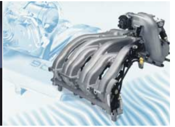
Ob aus Stahlguss, Aluminium, Magnesium oder Kunststoff – Komponenten für das Luftmanagement des Motors bilden ein zentrales Kompetenzfeld der Pierburg GmbH. Saugrohrmodule sind heute zumeist mit Drosselklappenstutzen, Abgasrückführventilen, Leerlauföffnungsstellen oder Steuerventilen versehen. Zu den ersten neuen Produkten aus dem Werk Nettetal gehörte 1990 ein längengeschaltetes Saugrohr für Audi (l.); das Saugrohr für einen V6-Zylinder-Motor (r.) wurde erstmals auf der IAA 1997 vorgestellt.
