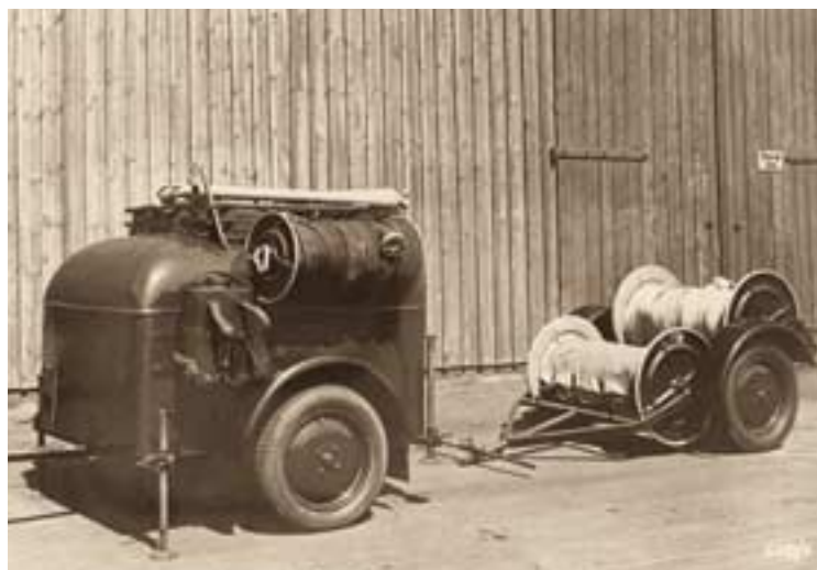
Von den heutigen Möglichkeiten zur Lösung der vielfältigen Aufgaben war die Werkfeuerwehr in Unterlüß noch weit entfernt, als sie 1912 lediglich ein Pferdegewiss und eine Handdruckspritze (Bild Mitte) besaß. Seit den dreißiger Jahren hatte sich die Ausstattung deutlich verbessert: Motorfahrzeuge mit ausfahrbaren Leitern und Schläuchen (Bild rechts) und Anhänger mit Sondergerät (Bild links) gehörten zur Standardausstattung der Feuerwehr.
